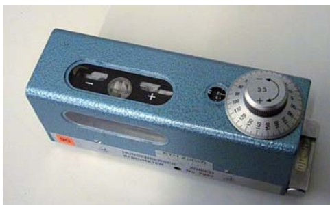
Klinometer (Huggenberger), Genauigkeit 0.2 mgon
