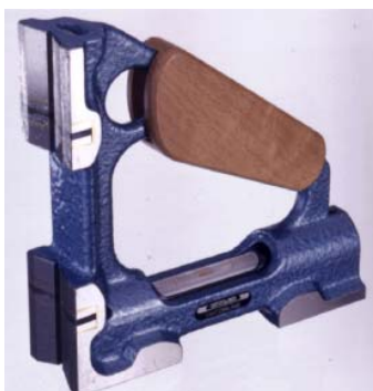
Klinometer (Huggenberger), Genauigkeit 0.2 mgon
